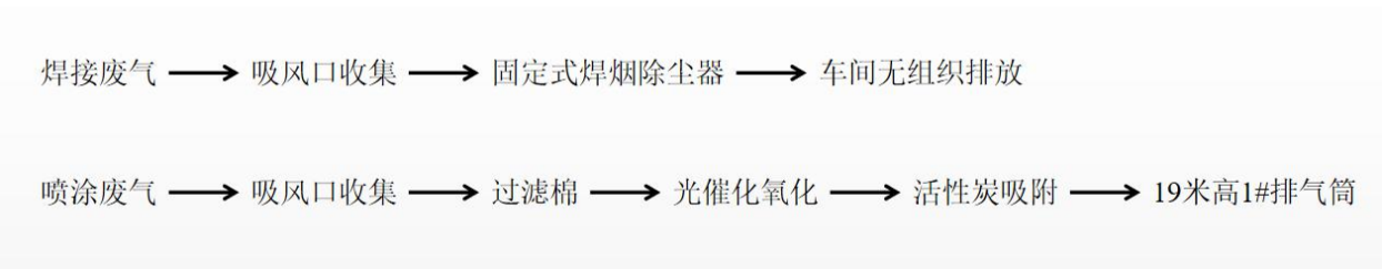
图 3-2 废气收集气路示意图
