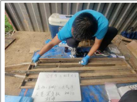
土壤 VOC 取样
